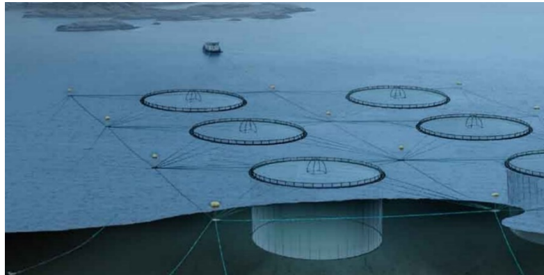
Mynd 2.3.4. Kerfisfestingar, eldiskvíar og fóðurprammi (www.akvagroup.com).
